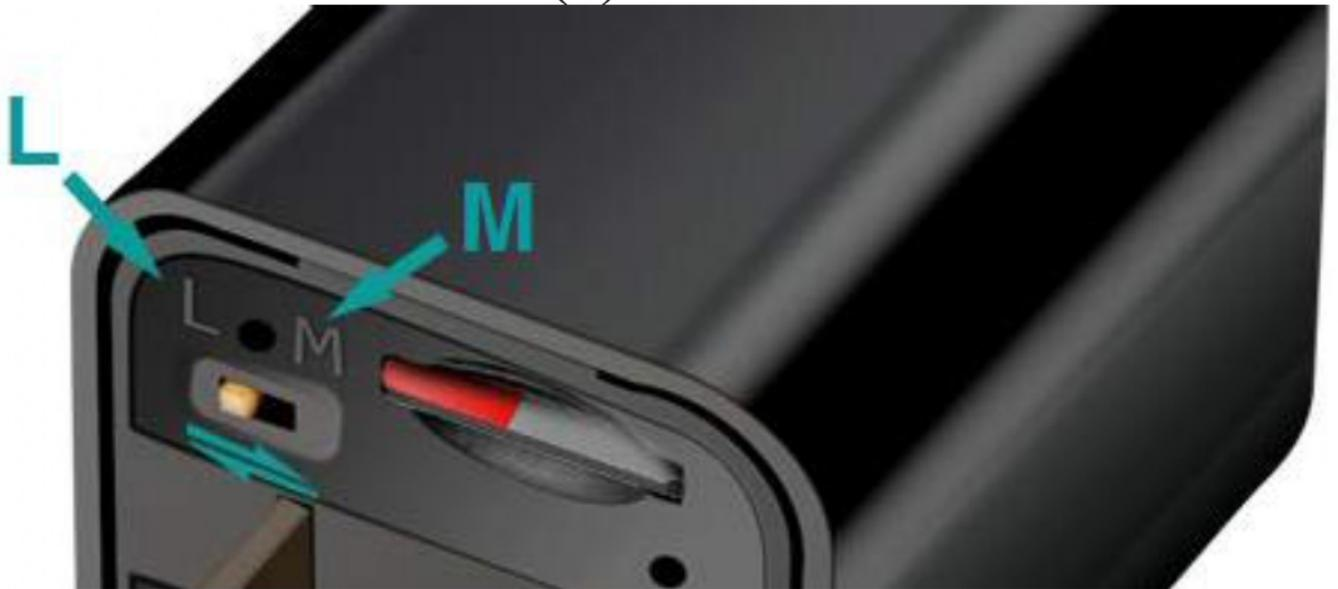
2 Modo de detección de movimiento: Cuando su Cargador Inteligente esté configurado en la posición “M” y esté conectado a la fuente de energía, la luz azul titilará 3 veces. En este caso, la cámara está configurada en el modo de detección de movimiento (la luz se apagará). La cámara comenzará a grabar automáticamente cuando el sensor detecte movimiento. El video se grabará como una serie de archivos de video de 3(5) minutos.
